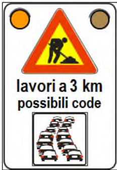
Figura 4: cartello di preavviso con lampeggiatori a led diam. 200 mm alta efficienza. Dimensioni 135x200 cm. Posizionamento sul margine destro su cavalletto a circa 3.000 m dal triangolo "lavori in corso".
