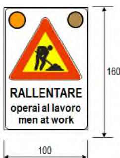
Figura 18: pannello composito di presegnalazione per lavori eseguiti lungo le corsie di decelerazione o sulle rampe di svincolo, dotato di 2 lampade a led ad alta efficienza diam. 200 mm. Superficie della targa non inferiore a 1,5 mq con lato del triangolo lavori in corso non inferiore a 90 cm. Posizionamento sul margine destro in coincidenza dell’ago di inizio della decelerazione e ripetuto in condizioni di non perfetta visibilità.
