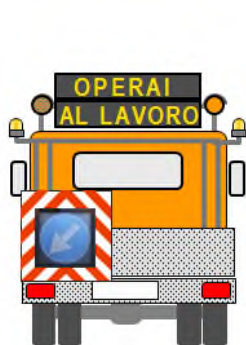
Figura 7: esempio di autocarro con PMV alfanumerico e disco direzione obbligatorio interamente a led.
