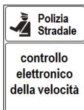
Figura 10: cartello di preavviso 90x135 da posizionare su cavalletto in anticipo rispetto alla posizione del box autovelox mobile
